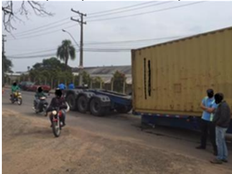
Figure 5 – Sinistro por desacoplamento involuntário do conjunto deslizante Porta-Container
